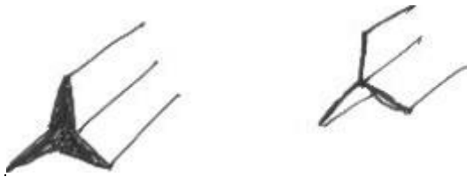
Abbildung 6 : Ansichten von stern- und strahlenförmigen Querschnitten
